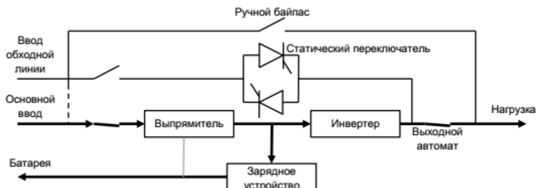
Рис. 1-2 Нормальный режим работы
