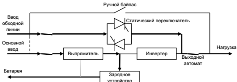
Рис. 1-4 Режим обходной линии
