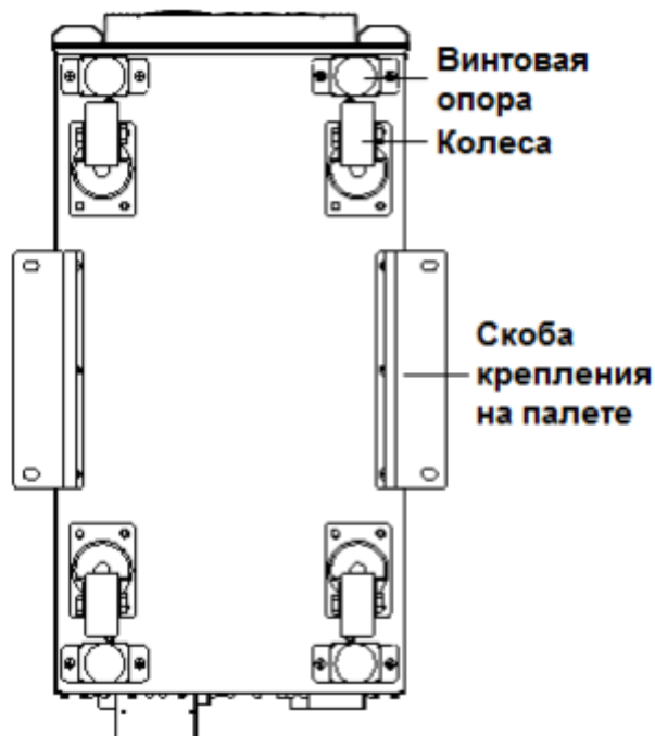
Рис. 2-8 Винтовые опоры и колеса (вид снизу)
