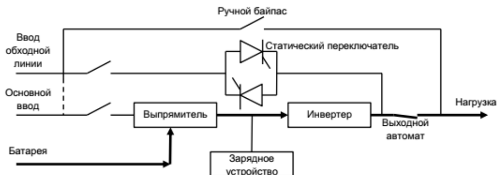
Рис. 1-3 Режим работы от батарей
