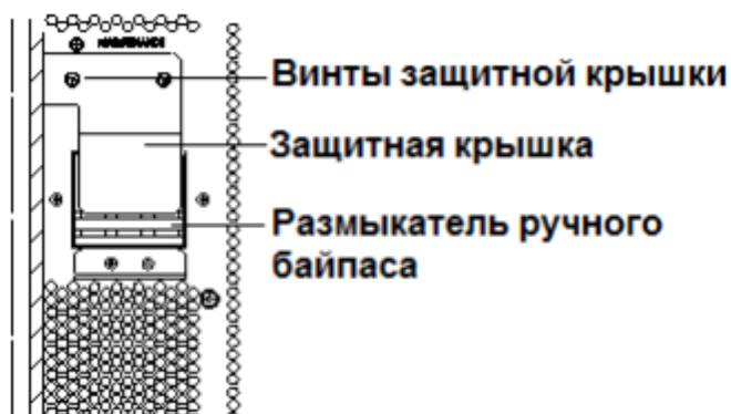
Рис. 4-2 Защитная крышка ручного байпаса
